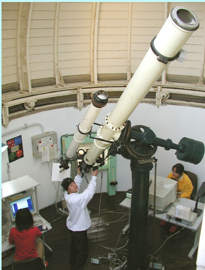
0.5Å幅のH \alpha リオフィルターとCCDカメラを装備したザートリウス18cm屈折望遠鏡H \alpha 単色像撮影システム
