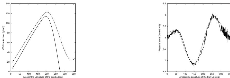
図1(左): 南緯 87.5 度における CO<sub>2</sub> 極冠の堆積量の季節変化。実線が南極のアルベドを北極のアルベドと同じ値にした場合、点線が北極よりも高くした場合。図2(右): 南極の地表面アルベドを北極よりも高くした場合の地表面大気圧の年間変動。実線がバイキングの測定データで、点線が我々の一次元モデルによる数値計算の結果。
