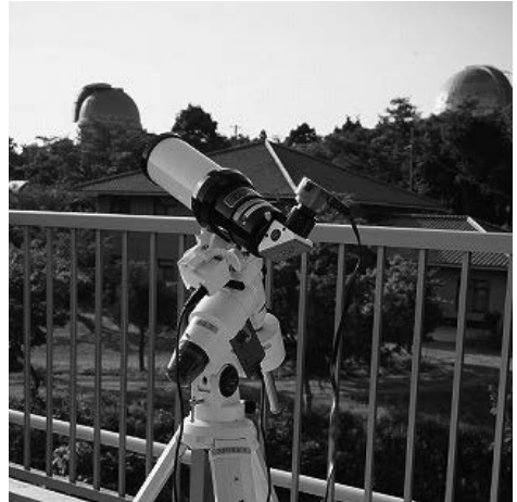
H \alpha 線フィルター小望遠鏡： 背景左側は別館で、右側は本館の45cm屈折望遠鏡ドーム
