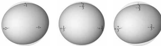
図4 潮汐ロック状態の衛星が受ける力は、潮汐力(左)と遠心力(中)が合わさったもの(右)になる。
