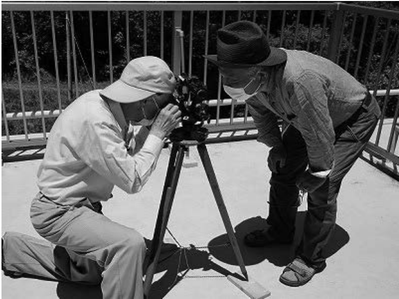
経度緯度測定用望遠鏡(経緯儀)による 南北線決定作業
