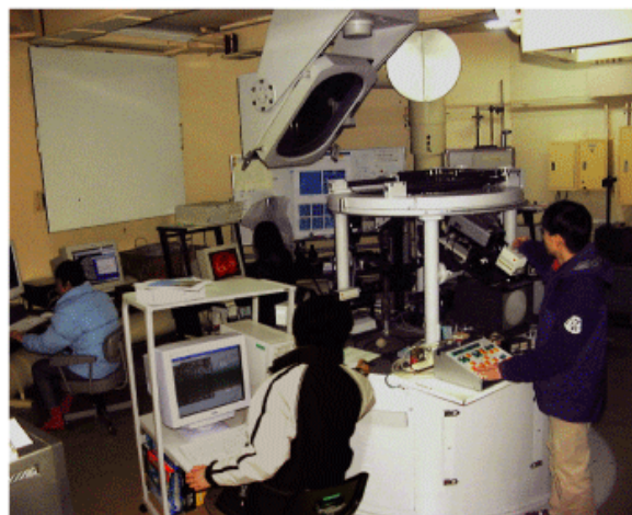
太陽像モニター部と分光観測部とからなる 1階垂直分光器焦点面での観測
