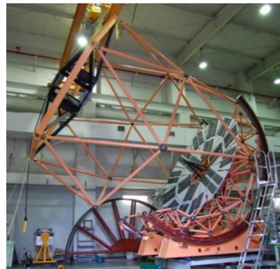
仮組された鏡筒と高度軸軸受
