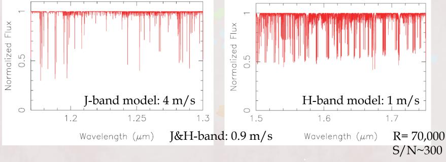
近赤外の波長域のスペクトルで1m/s以下の精度が達成可能
