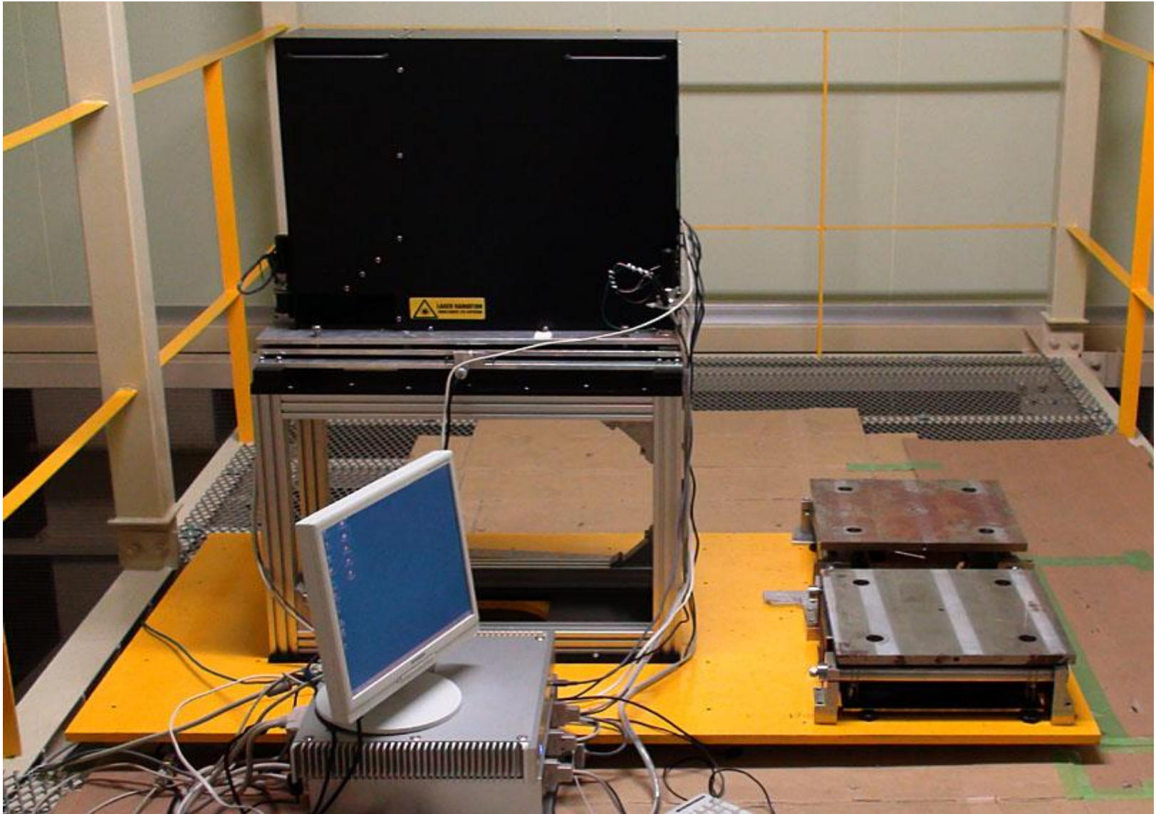
図1 測定塔上に設置したCGH干渉計。右の2個の鉄板は測定塔の振動を抑えるための制振装置。
