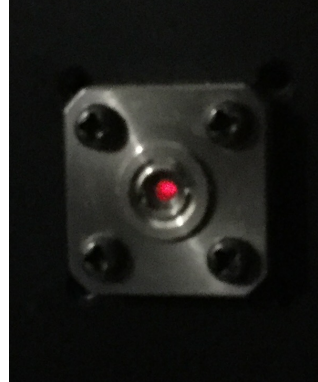
高さ, 角度 100um, 1分角で調整完了
