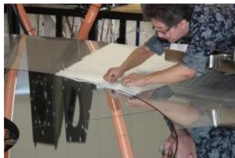
小ボトル半分程度の水で周辺部をノズルで端まで濡らす。内周側の幅10cm程度は流れた水で自然に濡れるので水をかける必要は無いが、内周側が均一に濡れるように水の流れが少なそうな部分には少し水を追加する。
