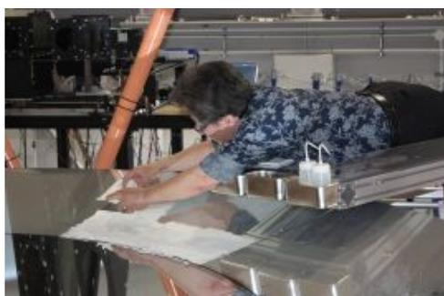
コットンシーガルをセグメントの形状に合わせて1/3程度重なるように並べる。後で一気に全部がめくれるように同じ方向に重なりができるように並べる。
