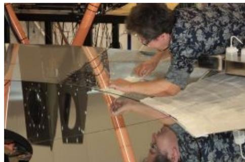
コットンシーガルの端が少しだけ鏡面に触る状態まで持ち上げて少しずらすと、触っている部分に汚れが集まるので汚れた部分を巻き取り、また少しずらして巻き取るを繰り返す。
