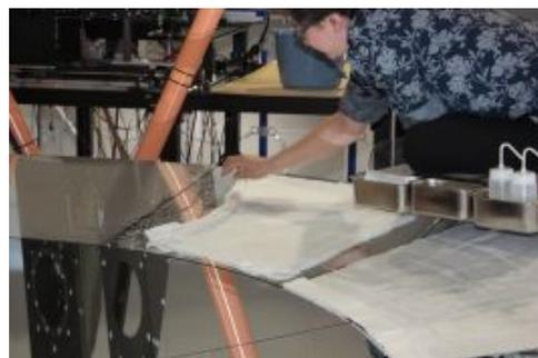
一気に反転させて着地させる。位置がずれても横ずれさせずにうえから軽くポンポンと押さえる。
