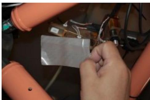
清掃中の水は全て光軸側に流れるので、内側のセンサアーム背面に付いている参照センサ真上に養生テープの接着面を2つ折りにしたものでひさしを作っておく。
