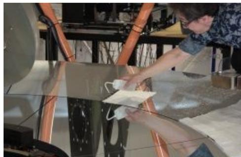
コットンシーガルを1枚置いて十分に蒸留水で濡らす。
