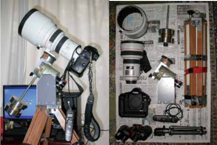
今回使用した機材、フード、レンズ(200mmF1.8)、カメラ、双眼鏡(50×10)、 バランスウェイト、ポタ赤、リモコン、小型三脚、歩タ赤用三脚
