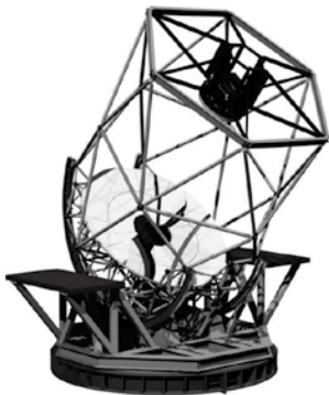
図2：京大岡山3.8m新技術望遠鏡の完成予想図。18枚の鏡を組み合わせる分割鏡方式で、独特な構造の軽量架台となっている。
