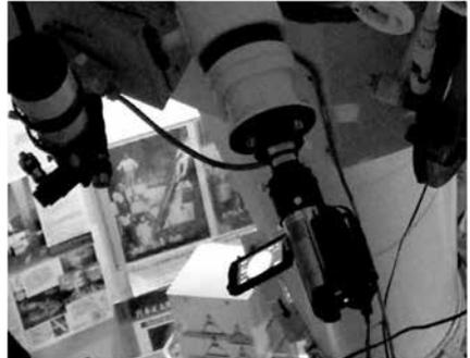
写真 1. 45cm 屈折赤道儀の接眼部に取り付けたビデオカメラ
