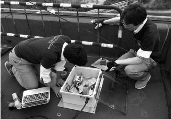
図 2 学術系クラウドファンディングのサポートも得て新たに開発した小型の放射線検出器を金沢大学の屋上に設置している様子。
