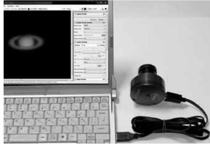
写真 2. CMOS カメラ(ZWO-ASI224MC)と制御ソフトの画面(はめ込み)
