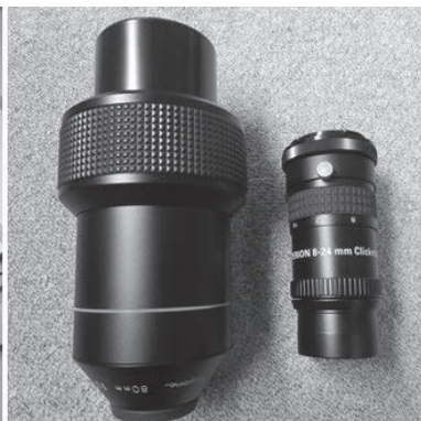
写真4：(右)今回写真撮影に使用した アイピース Hyperion 8—24mm Click stop Zoom (左)MASUYAMA 80mm 52度日本製
