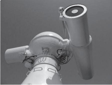
かげろうなどの空気の揺らぎの影響を受けないように、高い所にドームをつけずに設置している。太陽光の通り道も真空になっている。建物自体も熱くならないように冷却器も使っている。
