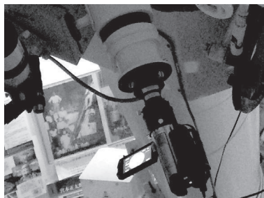
図 2. 45cm 屈折鏡の接眼部に装着されたデジタルビデオカメラ
