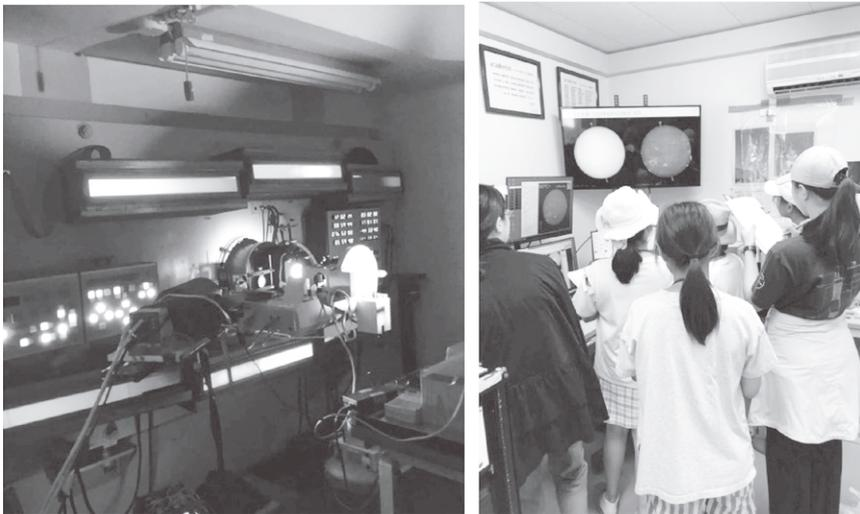
図3 (左) ドームレス太陽望遠鏡の下の分光装置が置かれている部屋にて。リアルタイムの太陽光を虹色に分けている。(右) 太陽磁場活動望遠鏡によるリアルタイムの太陽像がモニターに表示されている。左が白色光、右がH $\alpha$ 線を見た太陽。
