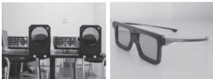
図3 プロジェクター用偏光レンズ(左)と偏光メガネ(右)
