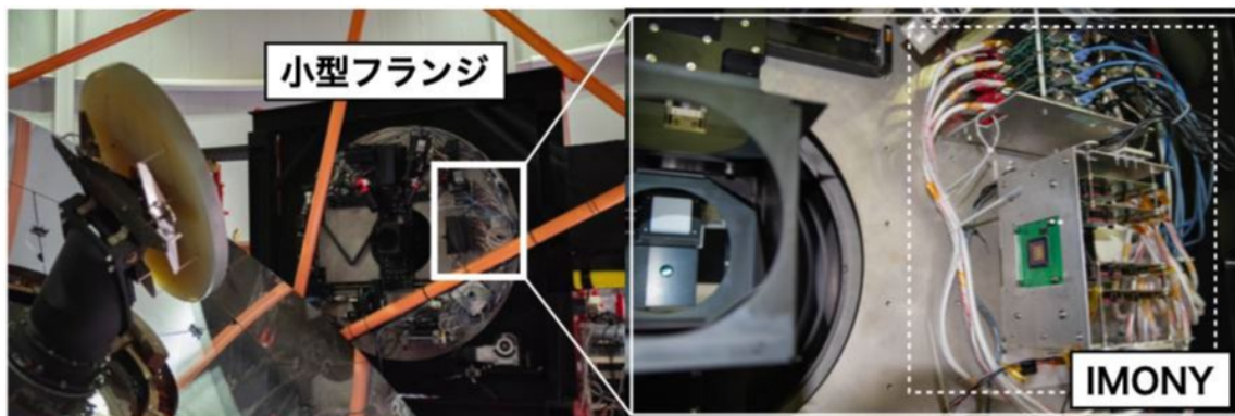
図1. せいめい望遠鏡の小型フランジ上に搭載された高速撮像システム IMONY。点線で囲まれた装置のうち、下段の筐体にはセンサと光子検出判定のためのフロントエンドボード、上段の筐体には時刻付与の要となる FPGA ボードと GNSS モジュールが搭載されている。
