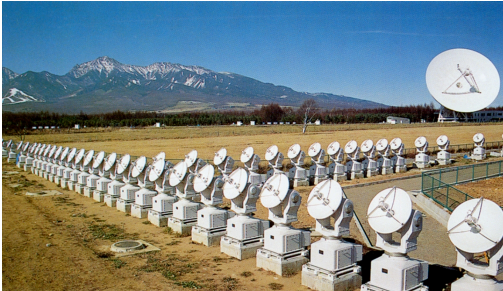
太陽電波干渉計（電波ヘリオグラフ、1992年） 口径80cmのアンテナを84台
