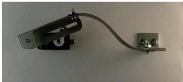
(a) 飛び移り座屈現象を用いた移動原理
