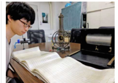
京大に残っていた印画紙による過去の地磁気の記録。奥にあるのは当時用いた観測機器（京都市左京区・京大）
